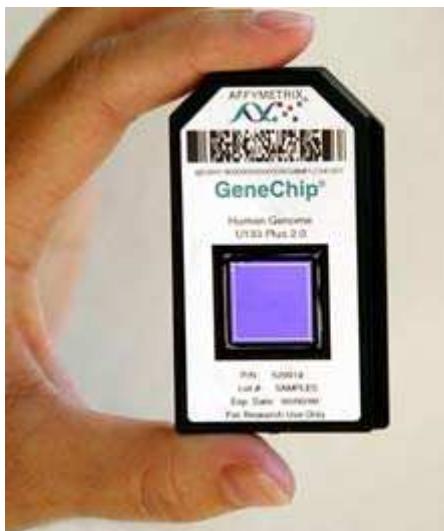
Figura 3: Biochip para test genéticos. Fuente: Affymetrix.
