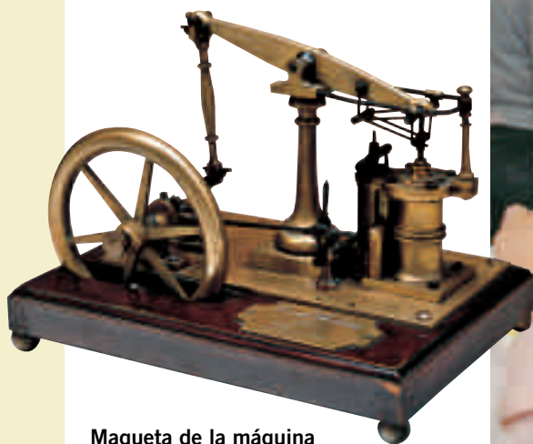
Maqueta de la máquina de vapor de balancín de James Watt (1880-1890).
