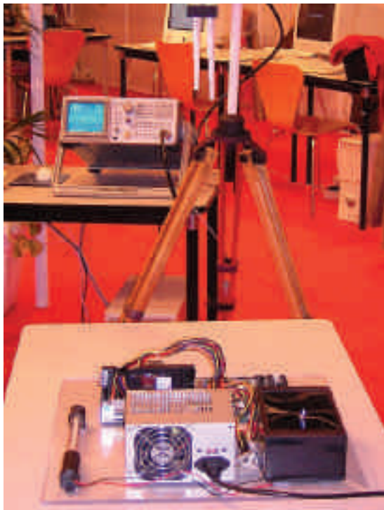
Montaje del experimento. Arriba: medidor y antena. Abajo: placa base y fuente de alimentación de un PC.
