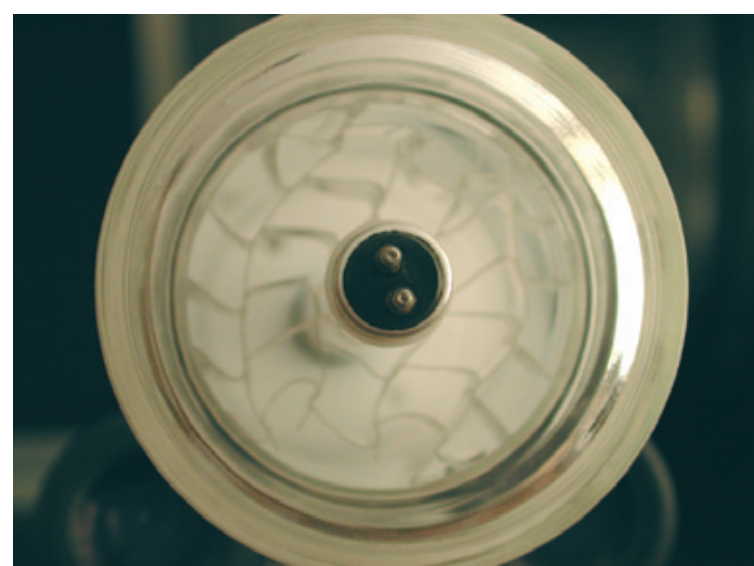
Reactor fotocatalítico anular con TiO 2 soportado sobre monolito plástico
