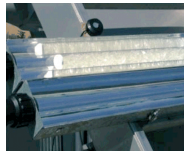
Fotorreactor experimental con colector cilíndrico compuesto (CPC) expuesto al sol
