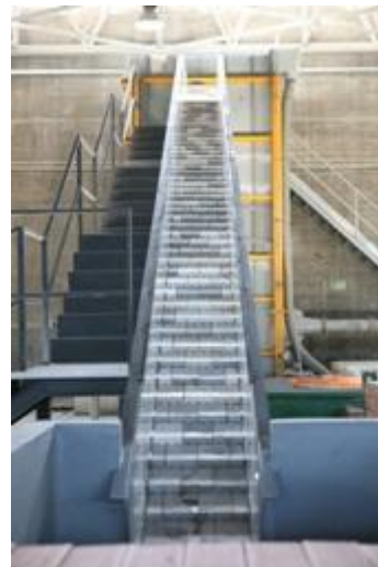
Instalación para experimentación de protecciones en forma de cuña en presas de materiales sueltos
