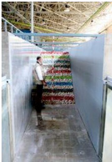
Instalación para experimentación del comportamiento de presas de materiales sueltos ante sobrevertidos por coronación
