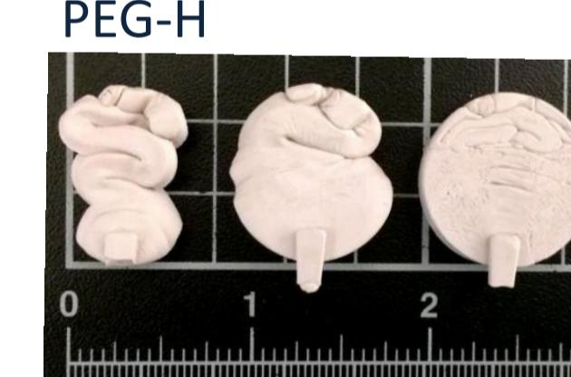
En el F3 se distingue el flujo de inyección inicial, éste podría no fundirse con el resto del material
