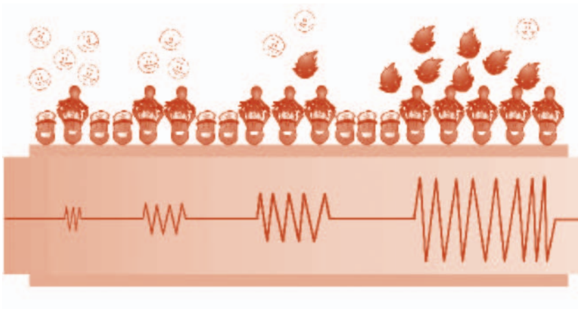
FIGURA 6. Biosensor piezoeléctrico. Como consecuencia de la interacción entre el elemento de reconocimiento y el analito se produce un cambio en la frecuencia de resonancia del cristal.
