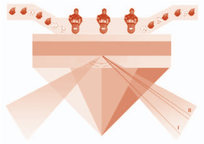
FIGURA 5.- Biosensor de resonancia de plasmones superficiales. El ángulo de luz incidente que excita a los plasmones de superficie varía en función de la concentración de analito que interactúa con el elemento de reconocimiento.
