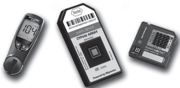
FIGURA 3 Ejemplos de dispositivos de diagnóstico in vitro (de izquierda a derecha: biosensor de glucosa Accu-Chek ®8 Active System, microarray de ADN Amplichip ®9 , Protein LabChip ®10 ).
